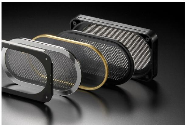
Společnost Stax využívá principu elektrostatického měniče. Pro aktivaci systému je třeba použít speciálního zesilovacího prvku, který dodává vysoké stejnosměrné polarizační napětí na ultratenkou pokovenou membránu uloženou mezi dvěma paralelně umístěnými elektrodami. Je-li pak na elektrody přiveden zvukový signál membrána svým pohybem v elektrostatickém poli vytvoří vlnění, které ucho a mozek vyhodnotí jako zvukovou informaci. Především díky technologii umožňující výrobu speciálního materiálu s
